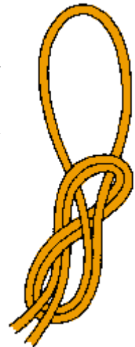
a) osmičkový uzel k navázání lana na pevný bod nebo na karabinu
